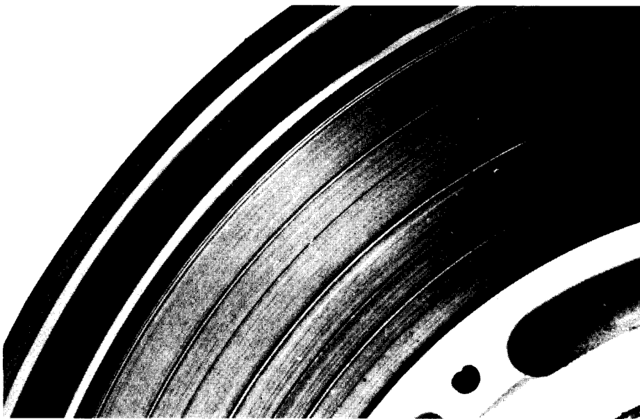
Schlechte Höhenführung: Die Wickel werden stufig (Abb. 12)
